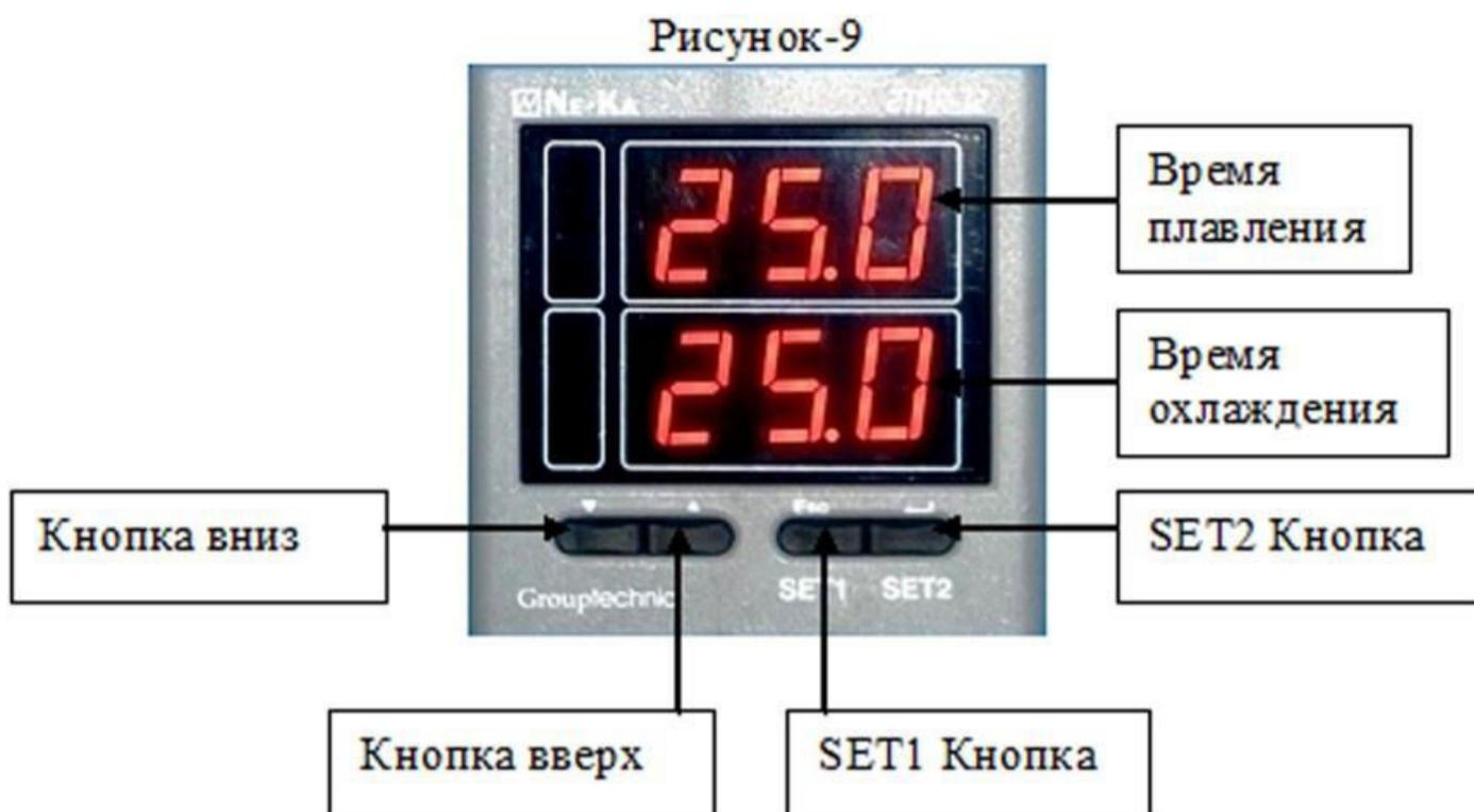
**Время плавления:** Показывает время плавления профиля.
